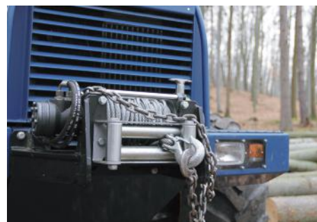
Lisaseadmena saab paigaldada hüdraulilise vintsi
